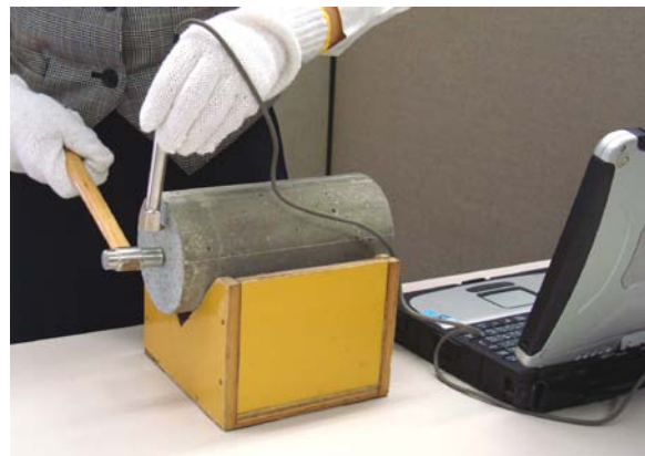
写真-3 反射波法による弾性波速度測定状況
